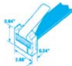
Рис. 3. Разъём JTAG-порта эмулятора
